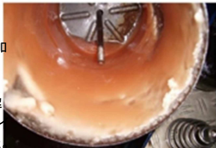
図-3 ワックスによる フィルタの閉塞
