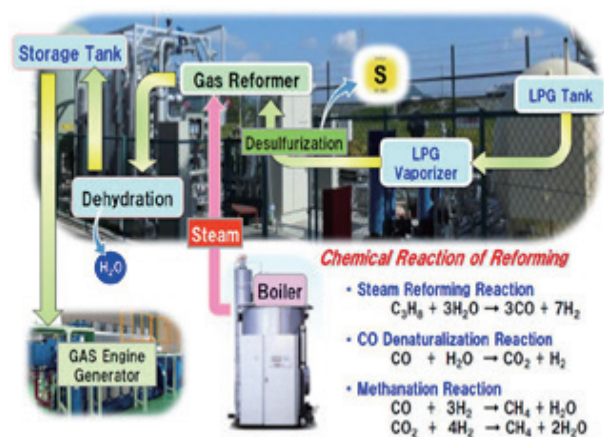
図2 一般的な改質プロセス
