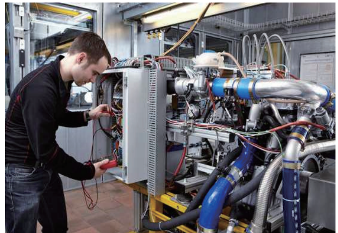
図 3-9 ディーゼル点火天然ガスエンジンテストベッド
