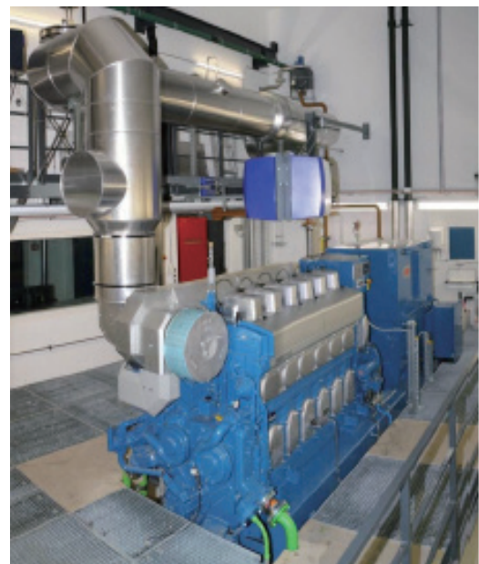
図 3-5 PSI のシリン内径 200mm、6 シリンダテスト設備 10)
