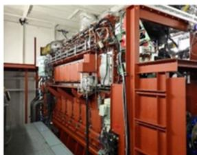
アンモニア燃料船用4ストロークエンジン実機 (IHI原動機)
