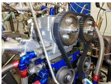
図 5-6 ICE2025+プロジェクトで使われている単気筒機関テストベンチ
