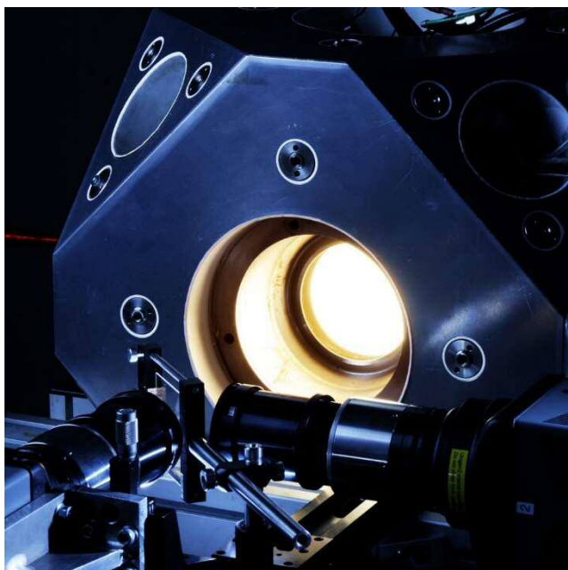
図 7-2 アイントホーフェン高圧セル
