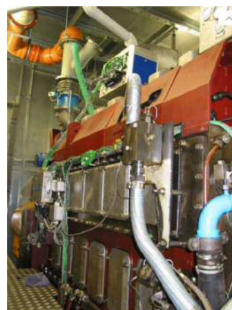
図 2-3 Caterpillar MaK 6M20 テストエンジン
