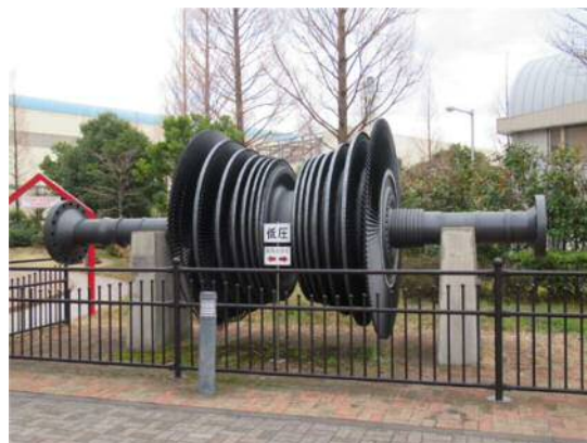
写真 3 低圧蒸気タービン
